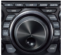
Dial exterior de VFO multiuso
