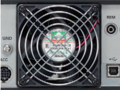
Ventilador de refrigeración de bajo nivel de ruido de \phi 80 mm
